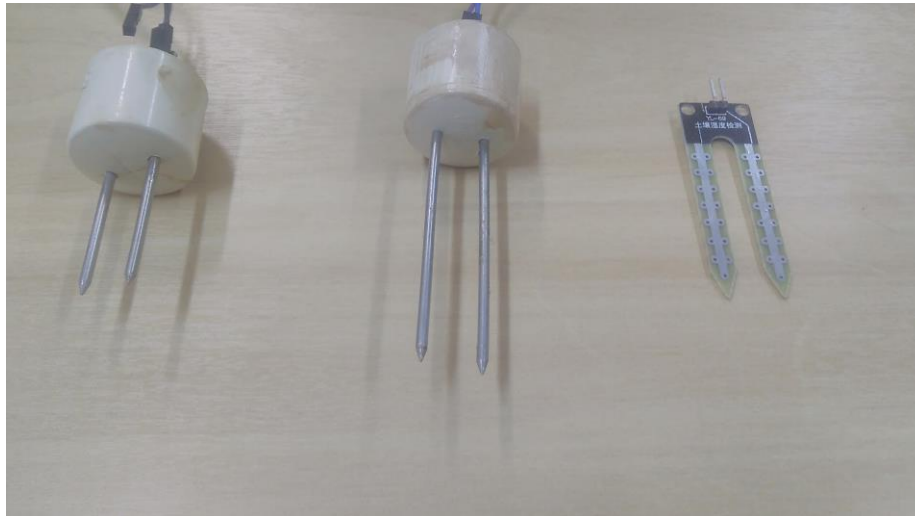
Figura 7: Sensores com hastes modificadas – à esquerda – e sensor com haste original – à direita.
