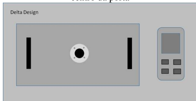
Figura 4.2 - Vista frontal da câmara térmica com a cavidade de corpo negro no centro da porta
