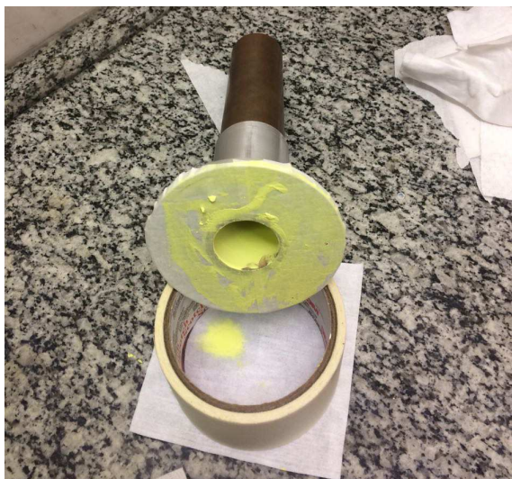
Figura 4.3 - Cavidade de corpo negro com primer .
