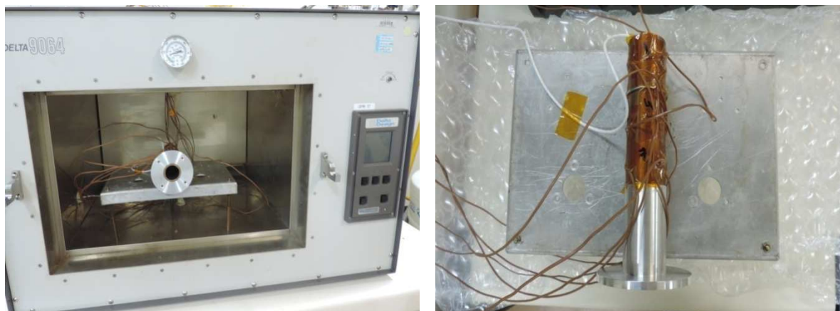
Figura 4.10 - Teste 2 - montagem da cavidade com os sensores no interior da câmara.
