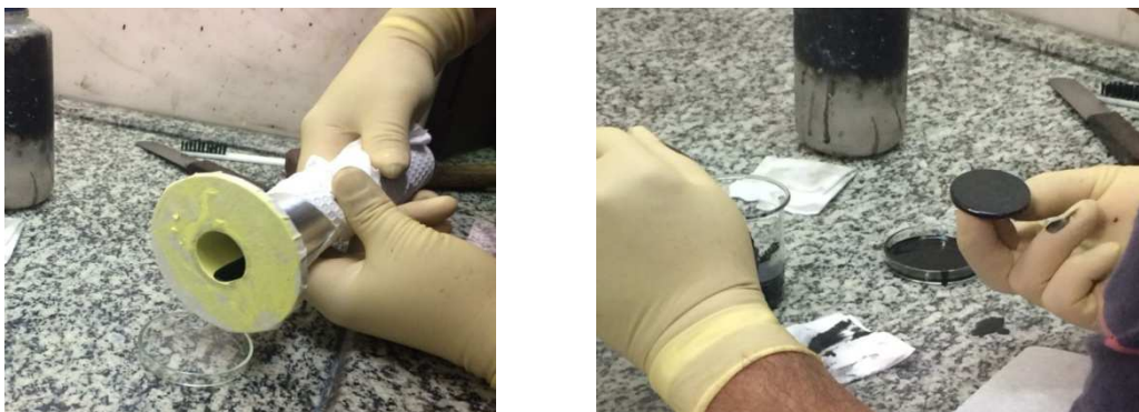
Figura 4.4 - Pintura da cavidade de corpo negro e do corpo de prova
