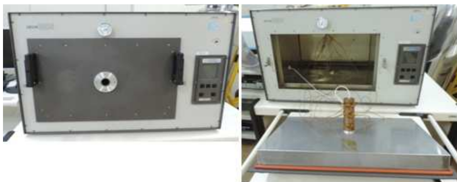
Figura 4.9 - Teste 1 - cavidade montada na câmara conforme projeto e sensores posicionados na parte externa da cavidade.
