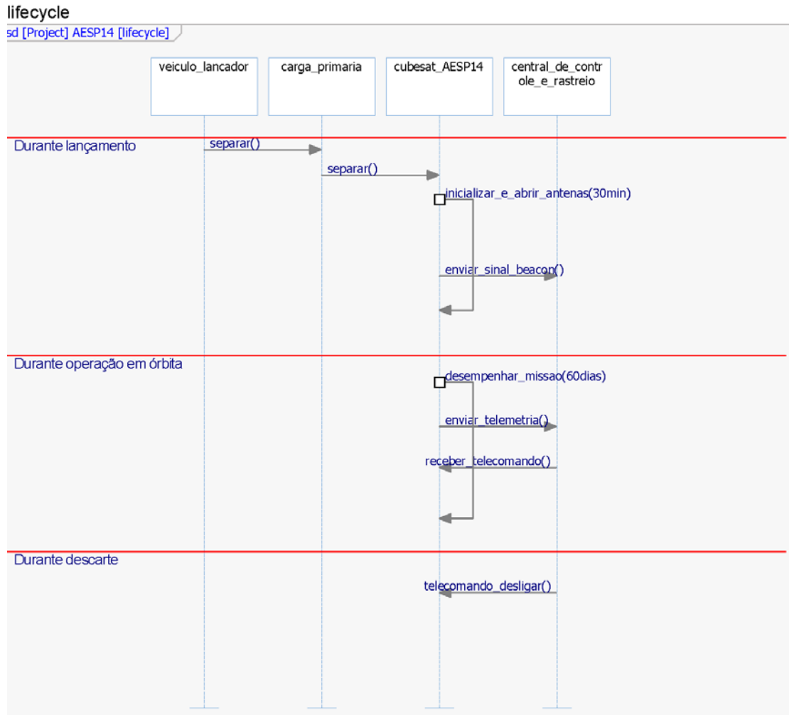
Figura 5.4 – Linha do tempo após lançamento modelado por sequence diagram
