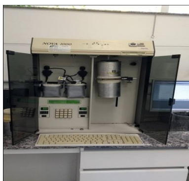
Figura 7 – Aparelho Quantachrome compreendendo duas estações: a de tratamento à esquerda; análise à direita.
