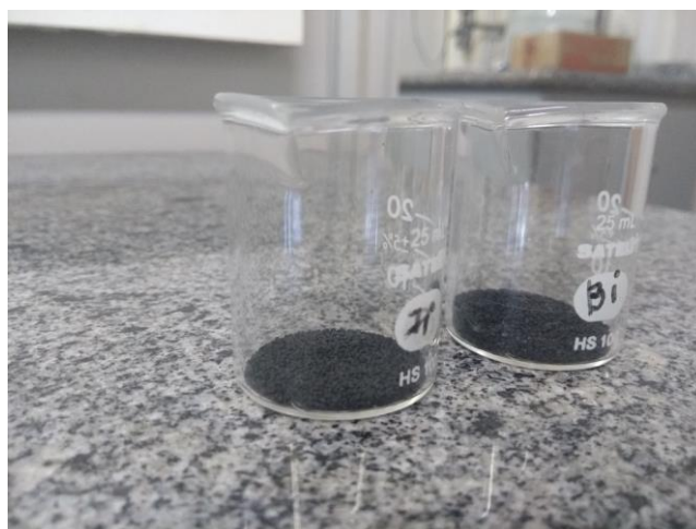
Figura 15 - À esquerda Ir/ Al 2 O 3 ; à direita Ir-Ru/Al 2 O 3 .
