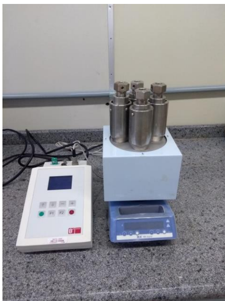
Figura 12 - Esquema do sistema de Digestão (da esquerda para direita: painel de controle, placa de aquecimento e reatores sob pressão mecânica).
