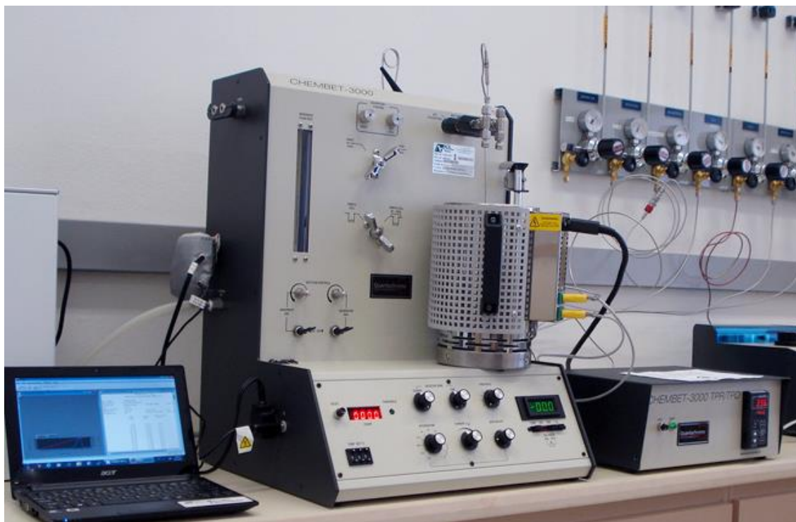
Figura 9 - CHEMBET 3000 → análise de Adsorção Química.
