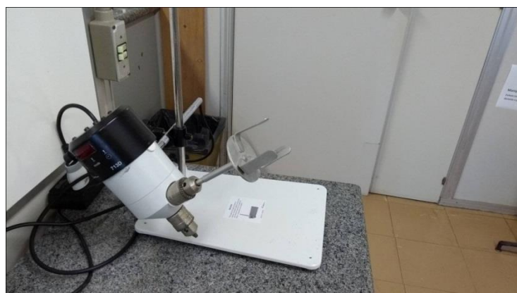
Figura 3 – Dimer usado para homogeneizar a alumina em impregnação.
