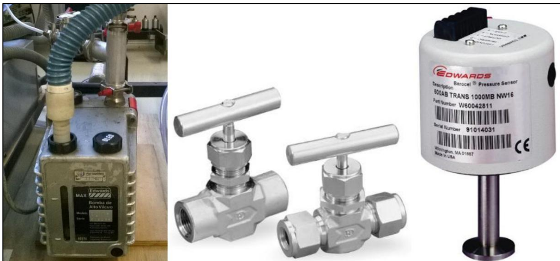
Figura 11 - Bomba de vácuo mecânica Edwards à esquerda, válvulas Hy-Lok tipo agulha ao centro e sensor Barocel 600 à direita
