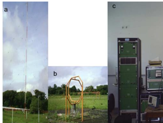
Figura 2.1: Fotos da digissonda do tipo DPS onde (a) é a antena transmissora, (b) é a antena receptora e (c) é o sistema de controle, pré-processamento e transmissão de dados.
