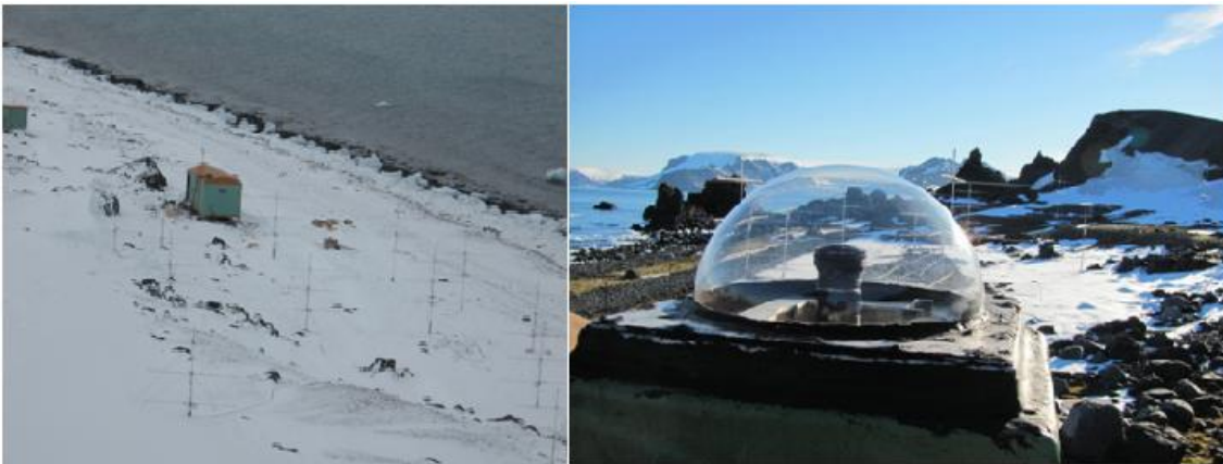
Figura 4: (A) Fotografia do módulo de observações de airglow, na EACF, onde se encontra o imageador all-sky . (B) Cúpula onde está instalada a câmera imageadora de ondas de gravidade, destacando-se no interior dela parte do sistema telecêntrico e a lente fish-eye .
