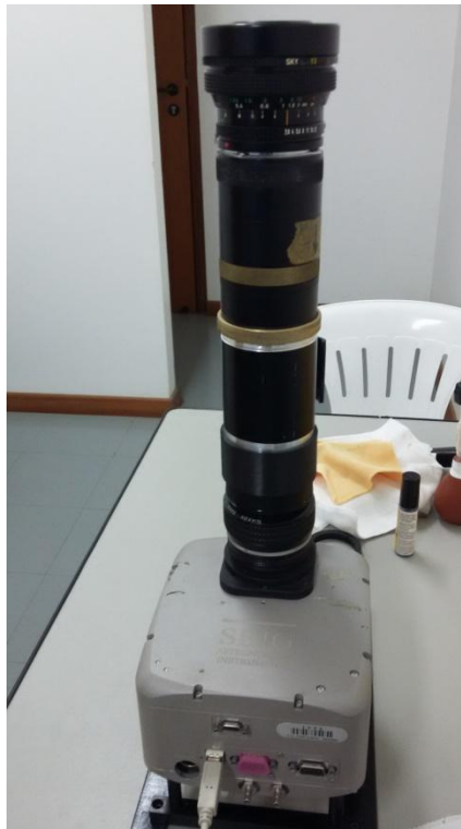
Figura 18: Foto do imageador que foi instalado no OES.
