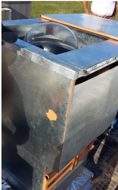
Figura 20: Foto do sistema automático de proteção da cúpula do imageador no processo de abertura.
