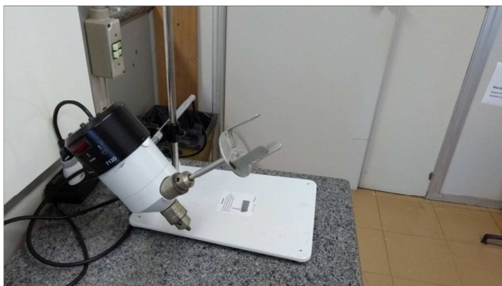
Figura 5 – Dimer usado para homogeneizar a alumina em impregnação.
