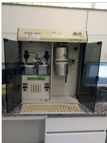
Figura 8 – Aparelho Quantachrome compreendendo duas estações: a de tratamento à esquerda; análise à direita.
