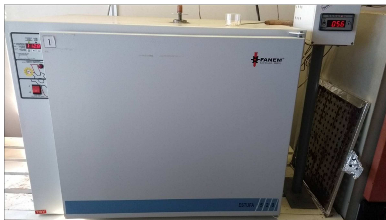
Figura 4 – Estufa para secagem e ativação do catalisador.
