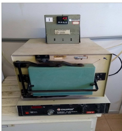
Figura 3 – Forno usado para a calcinação a 873K.
