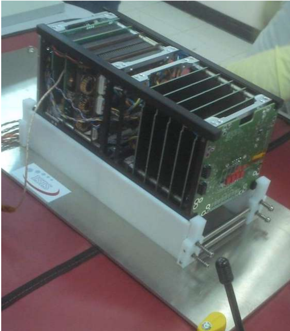
Figura 2: Foto do modelo de engenharia do CubeSat NANOSATC-BR1 no Laboratório de Integração e Testes (LIT/INPE-MCTI)
