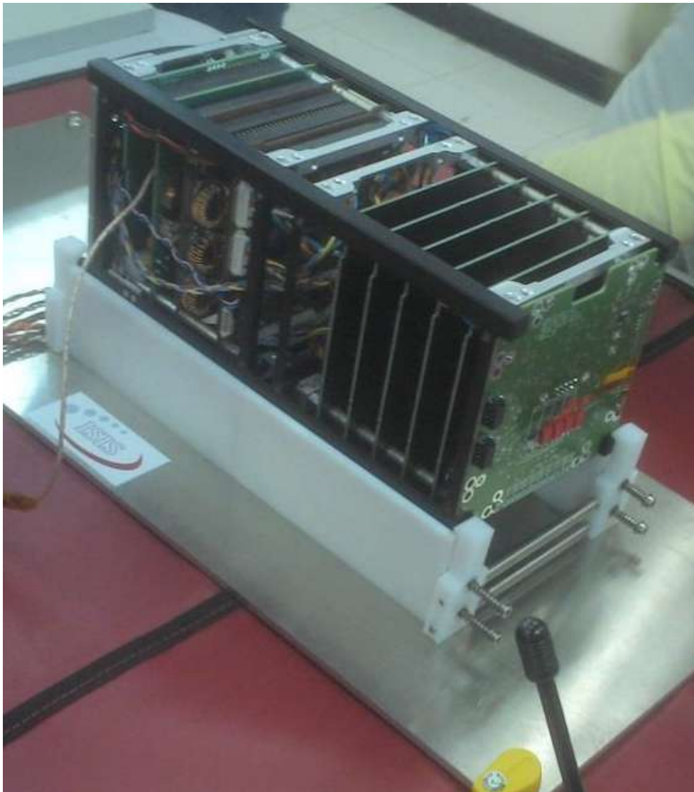
Figura 2: Modelo de Engenharia do NANOSATC-BR2 em testes de bancada.
