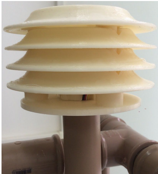
Figura 4: Shield Térmico impresso. Fonte: Elaboração própria.
