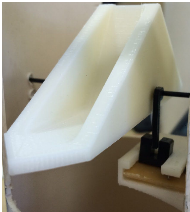
Figura 8: Balança, suporte do circuito e chave de interrupção do pluviômetro. Fonte: Elaboração própria.
