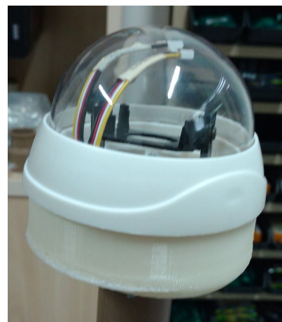
Figura 15.b: Montagem do suporte ao piranômetro.
