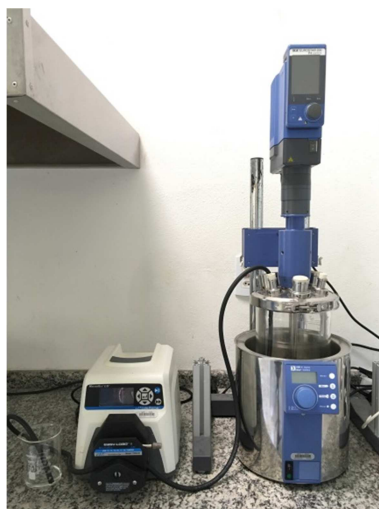
Figura 3 – Reator com agitação e banho termostático conectado à bomba peristáltica para injeção de reagente
