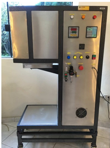
Figura 5 - Forno mufla utilizado na calcinação
