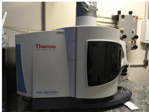
Figura 8 - ICP-OES utilizado nas análises
