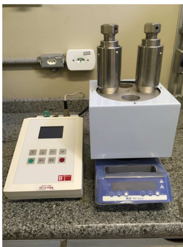
Figura 7 - Esquema de digestão ácida utilizado
