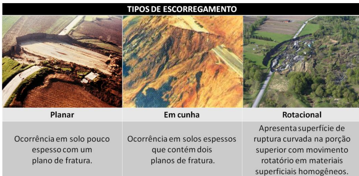
Figura 4.2: Tipos de escorregamento planar, em cunha e rotacional. Classificados de acordo com a espessura do solo, quantidade de planos de fratura ou ainda movimento do substrato (Fonte: Montgomery, 1992; Hungr et al. , 2014).
