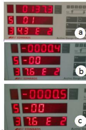
Figura 11 - (a) Medição de vácuo realizada inicialmente; (b) e (c) Medição posteriores à solução dos vazamentos no sistema.
