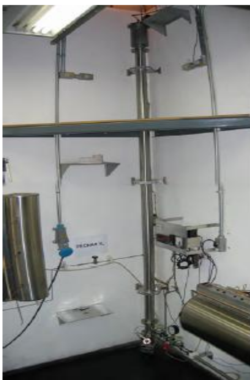
Figura 4 - Tubo de queda livre do LAS/INPE [3] .
