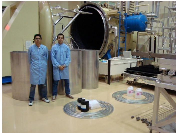
Figura 3.1 - Cilindros e flanges em frente à câmara de vácuo-térmica de 3x3 m.
