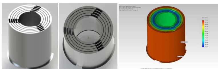
Figura 3.7 - Modelo do MNP utilizado nas simulações térmicas. À direita está uma plotagem térmica obtidas em uma das simulações.
