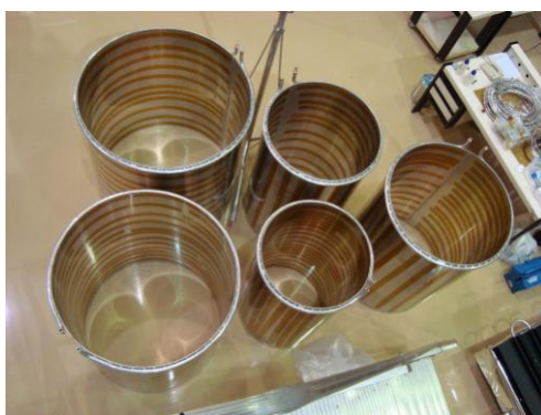
Figura 3.3 - Vista superior dos cilindros de cabeça para baixo, após serem parcialmente revestidos com fita Kapton.
