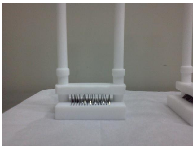
Figura 2: Suporte de Teflon utilizado para fixação das amostras
