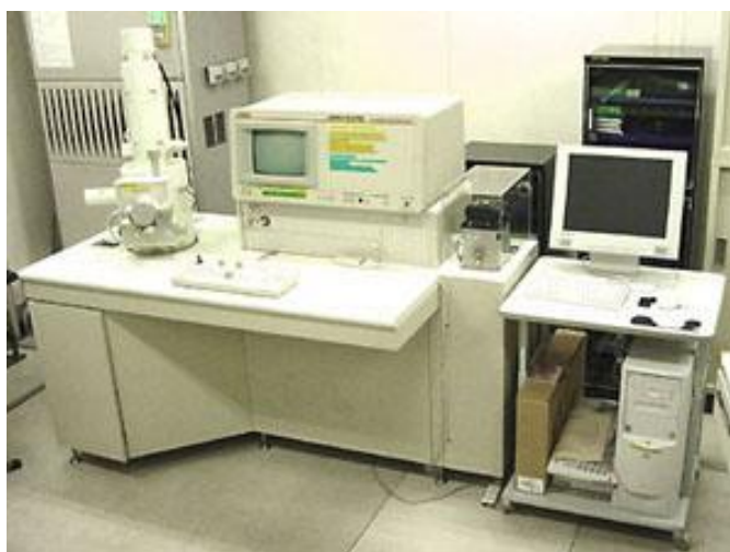
Figura 6: Equipamento utilizado para a Microscopia- Jeol JSM-5310 [6]
