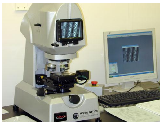
Figura 7: Perfilômetro óptico (Modelo NT 1100, Veeco)
