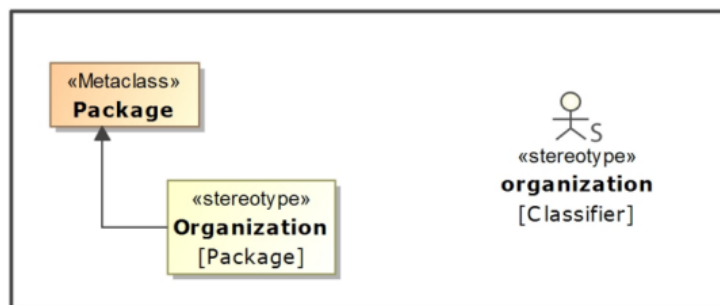
Figura 3.4 - Meta-modelo SysML estendido com estereótipos do tipo “ organization ” para análise de stakeholders
