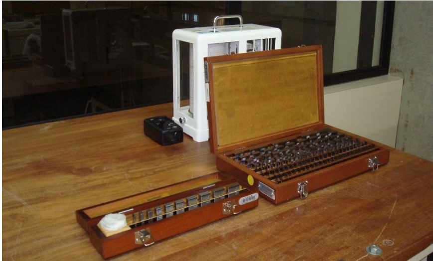
Figura 7 – padrões utilizados na calibração de paquímetros e micrômetros externos
