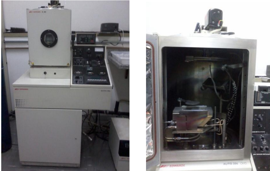
Figura 3: Aparelho de Electron Beam utilizado na metalização das amostras
