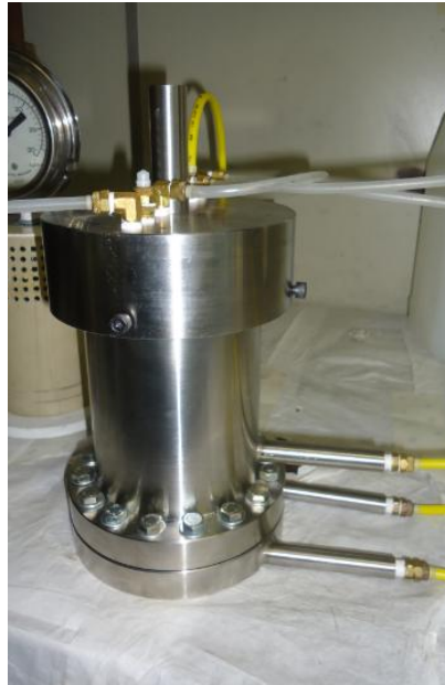
Figura 3.4.6 – Mangueiras refrigeração brancas
