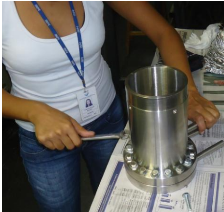
Figura 3.4.1- Montagem do tubo flange
