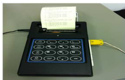
Figura 3.4.1 – Sistema de Aquisição Dataworker
