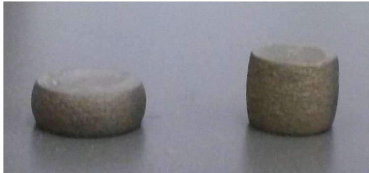
Figura 3.13 – Comportamento das ligas Ti-6Al-4V nos ensaios de compressão.
