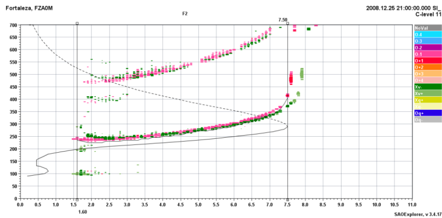
Figura 5 – Ionograma obtido às 21h (UT) do dia 25 de dezembro de 2008, em Fortaleza – CE e perfil ionosférico gerado após redução manual.
