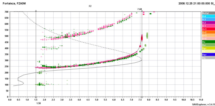
Figura 6 – Ionograma obtido às 21h do dia 25 de dezembro de 2008, em Fortaleza – CE e perfil ionosférico gerado a partir da redução automática do SAO Explorer.
