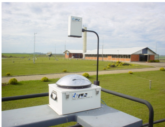
Figura 7.1. Imageador Total Sky Imager TSI-440 (YES, Inc) instalado na estação SONDA – SMS no Observatório Espacial do Sul – OES/CRS/CCR/INPE – MCTI.
