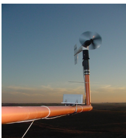
Figura 8.2. Equipamento de medida de dados eólicos da estação SONDA – SMS, instalada no Observatório Espacial do Sul – OES/CRS/CCR/INPE – MCTI.
