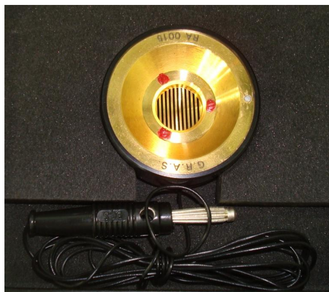
Figura-7 Atuador Eletrostático
