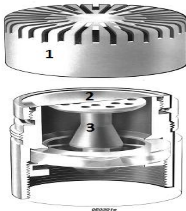
Figura 1- Figura esquemática do microfone padrão
