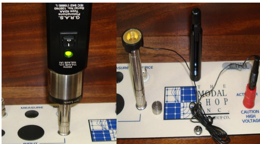
Figura- 8 (a) Comparação da sensibilidade do microfone utilizando pistonfone (b) Varredura de frequência utilizando atuador eletrostático
