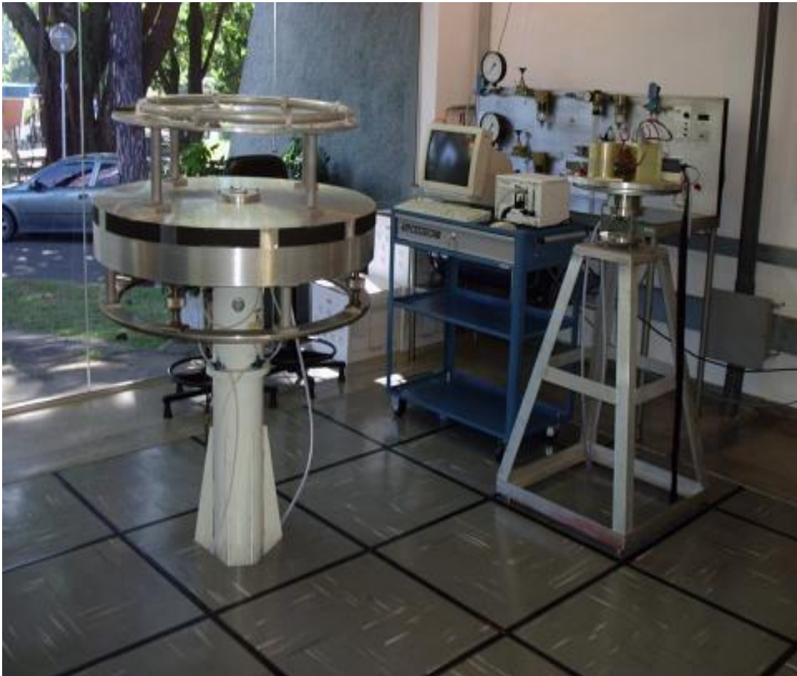
Figura 2.1 - Duas plataformas do LabSim: à esquerda rotação em 3 eixos à direita em 1 eixo
