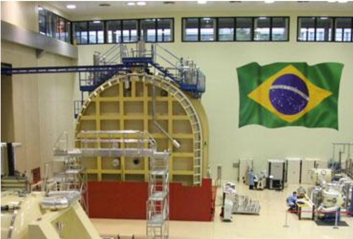
Figura 9 - Exemplo de Máquina Termo Vácuo
