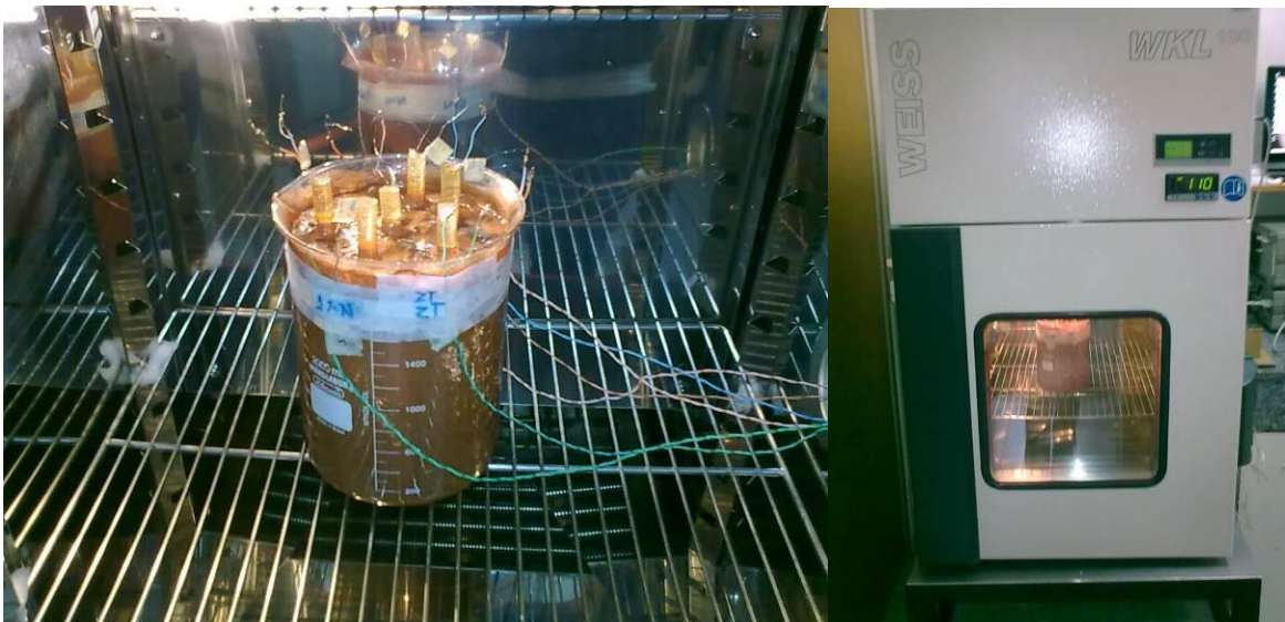
Figura 3.5: Sensores e solo onde foram efetuadas as medidas e Câmara climática onde foram realizadas as medidas.
