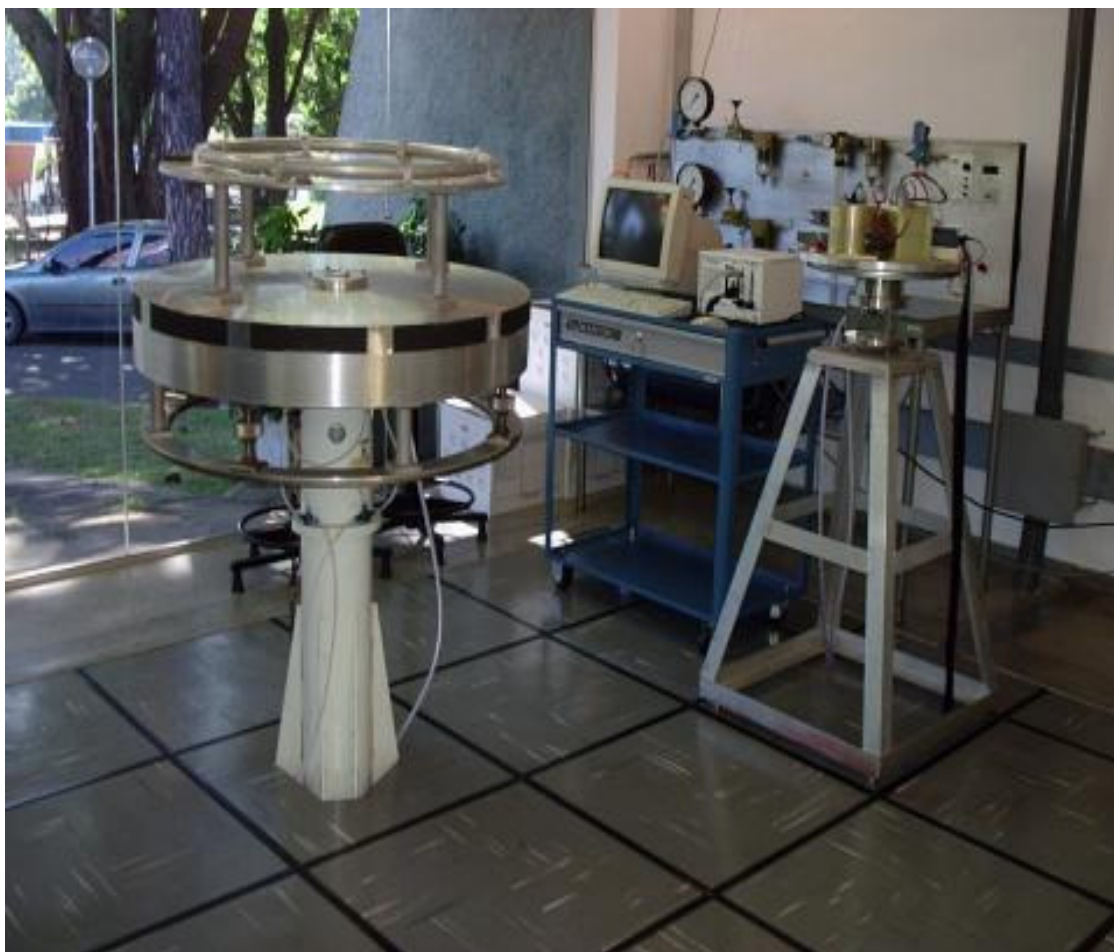
Figura 1 - Duas plataformas do LabSim: à esquerda rotação em 3 eixos à direita em 1 eixo
