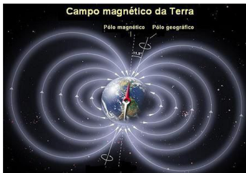
Figura 2.1 – Representação das linhas de força magnética do Campo Magnético Terrestre. No centro da imagem, representação de uma bússola indicando o eixo norte-sul magnético.
