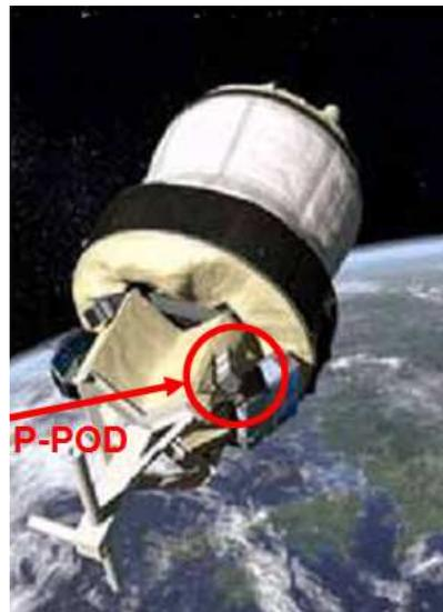
Figura 11: P-POD no último estágio do lançador
