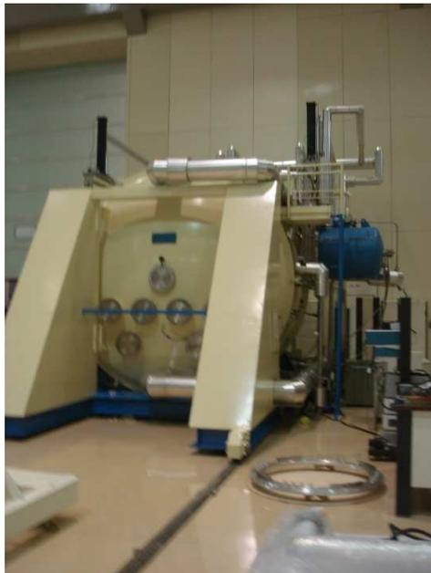
Figura 3: Câmara de Termo-Vácuo.
