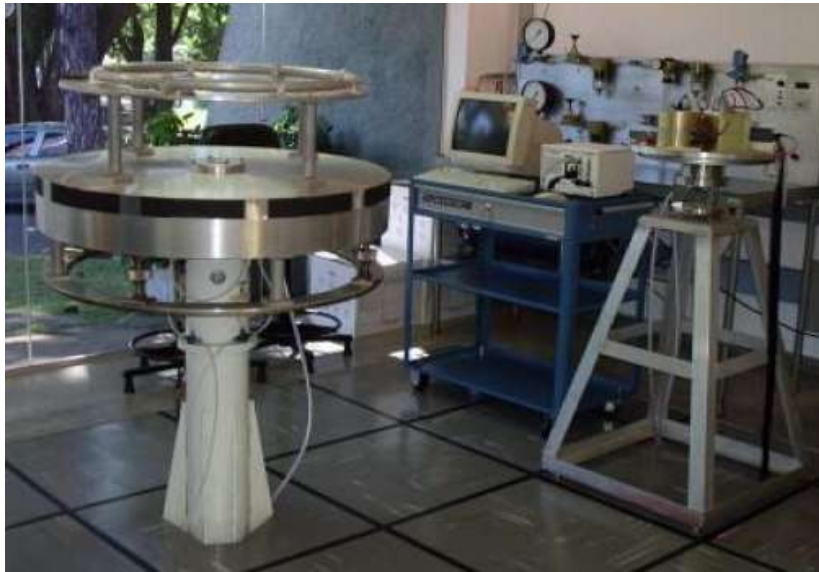
Figura 1: Plataformas do LabSim: à esquerda uma plataforma de três eixos de rotação e da direita de um eixo de rotação
