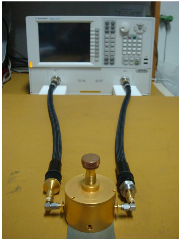
Figura – 3.10.2 Sistema de medidas com analisador de rede e caixa de teste
