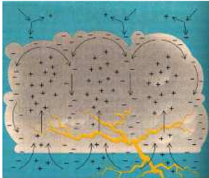
Figura 2.3 – Esquema do processo de eletrificação das nuvens de tempestade segundo o modelo da hipótese da convecção
