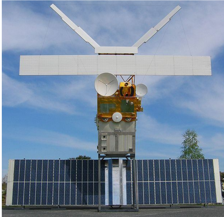
Figura 4.25 - Estrutura frontal do ERS
