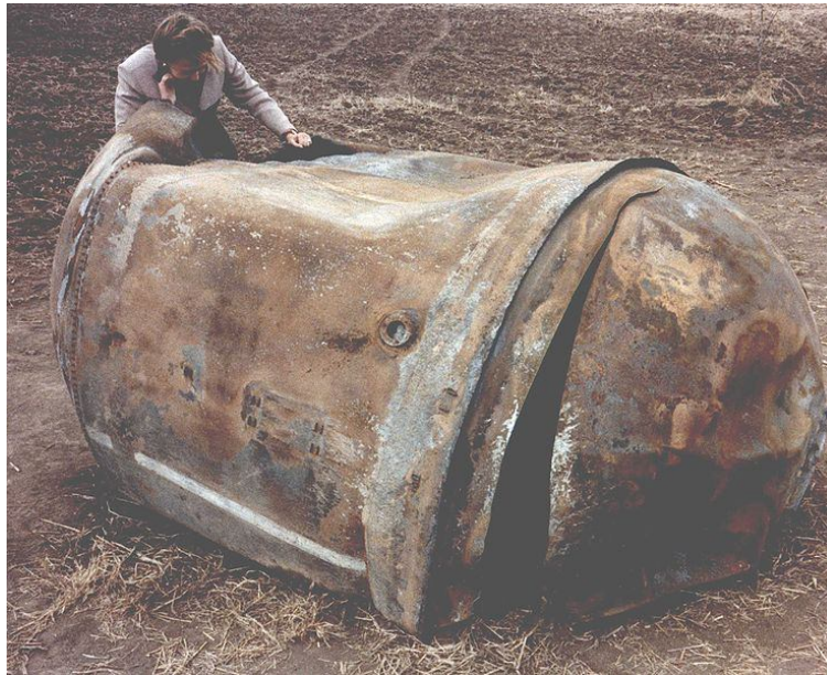
Figura 1.3 - Tanque de um Delta II que caiu no Texas em 1997
