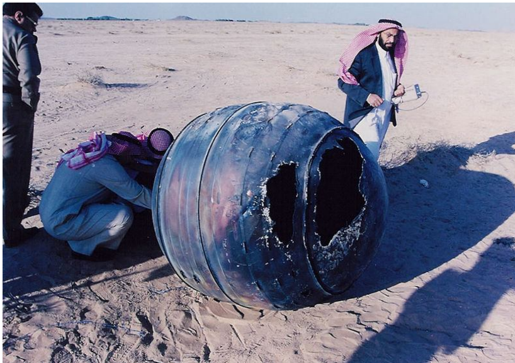
Figura 1.2 - Módulo PAM-D de um foguete classe Delta II, encontrado na Arábia Saudita.
