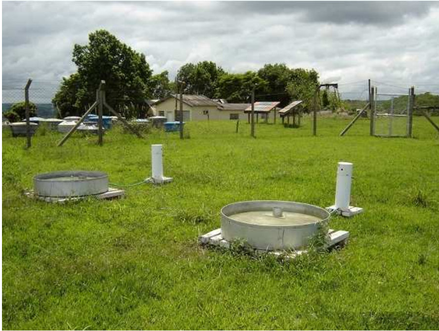
Figura 2.4 - Tanques Classe A ESALQ /USP – 2009
