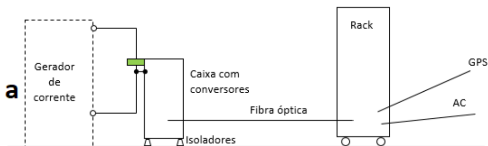
Figura 3.14 - Registro do segundo teste do sistema de sensor de corrente elétrica.
