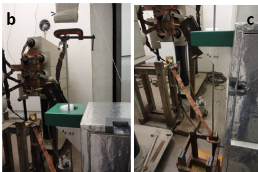
(a) Esquema do sistema; (b) Registro do gerador de corrente através do sensor Pearson; (c) Isoladores.
