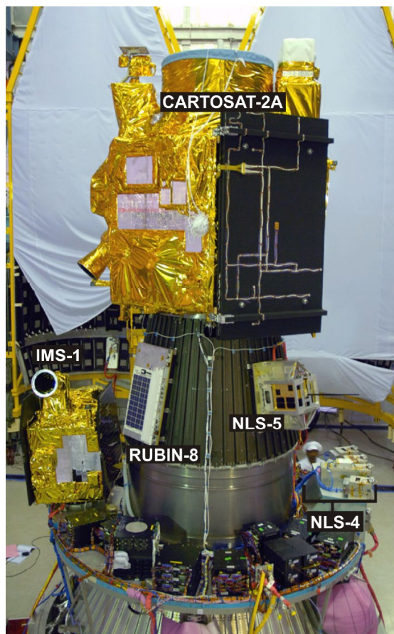
Figura 38: Quarto estágio do lançador, com os respectivos satélites. Fonte: http://www.isro.org/pslv-c9/photo/10.jpg
