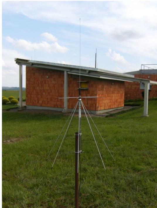
Figura 4.2.1 - Antena monopolo utilizada no Projeto e instalada ao lado do Prédio 6 no Observatório Espacial do Sul, em São Martinho da Serra, RS.
