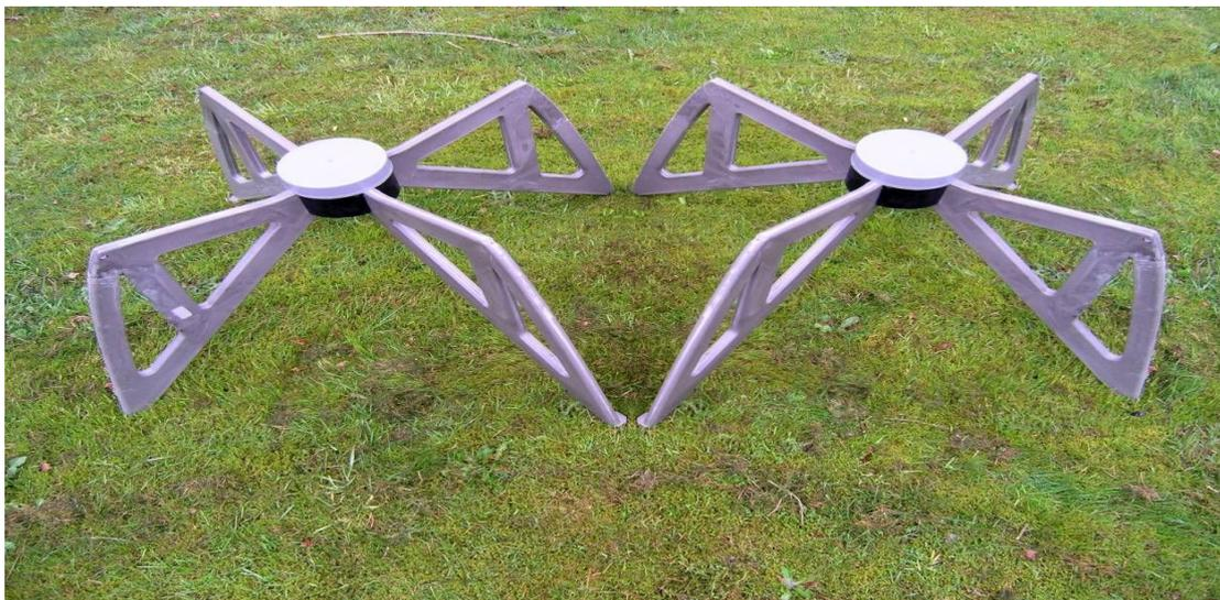
Figura 3.3.1.2 - Antenas de banda alta usadas LOFAR.
