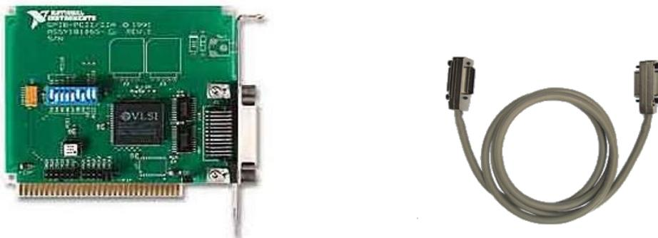
Figura 2.3.4.1 - *General Purpose Interface Bus* (GPIB): (a) Placa de GPIB 488.2 soquete ISA; (b) cabo de GPIB.
