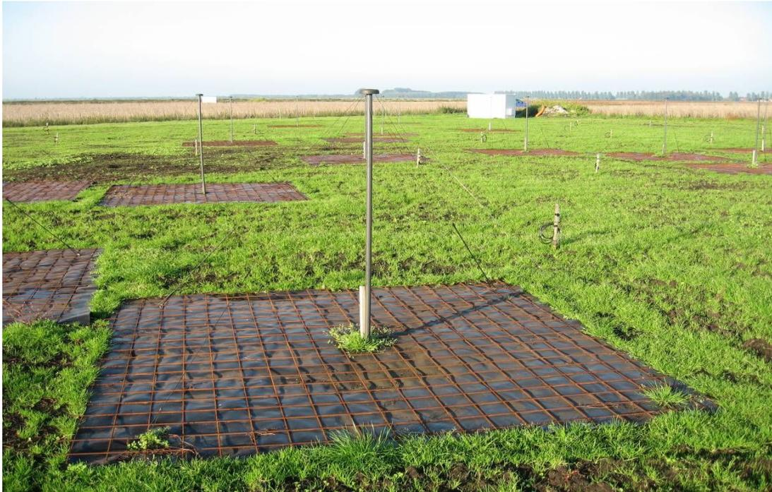
Figura 3.3.1.1 - Antenas de banda baixa operando em uma estação LOFAR.
