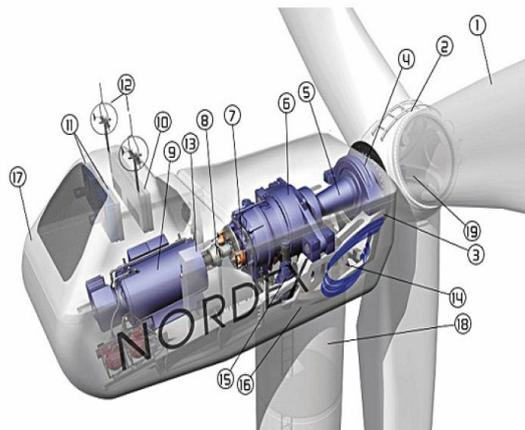
**Figura 5.5** – Principais componentes de um Aerogerador. Fonte: Amêndola (2007).
