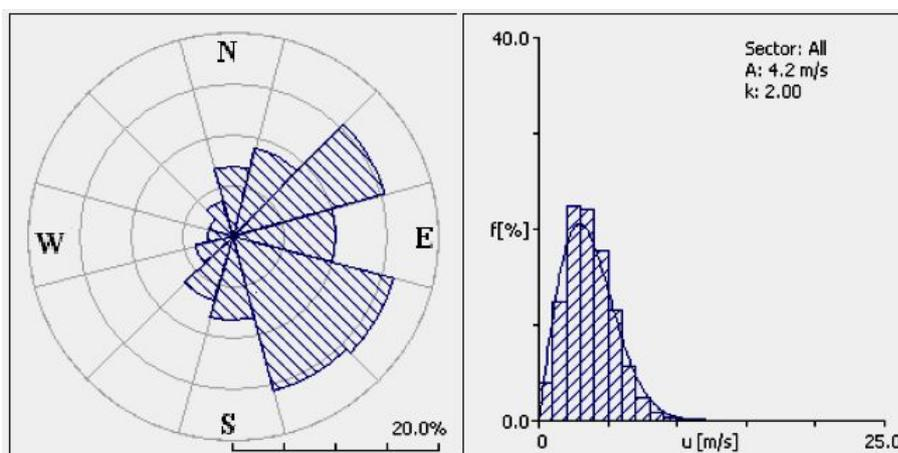
**Figura 9.1** – Distribuição estatística dos ventos a 10m de altura medida no Observatório Espacial do Sul – OES/CRS/INPE - MCT.
