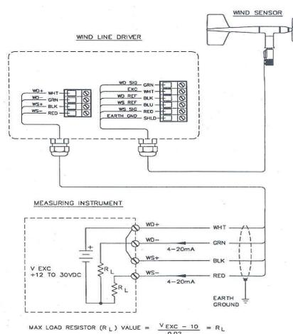
**Figura 8.2** – Diagrama do “Wind Line Driver”. Fonte: Campbellsci (2009).
