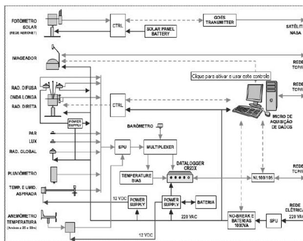
**Figura 7.4** – Diagrama da configuração local dos equipamentos instalados na estação SONDA – SMS. Fonte: SONDA (2009).
