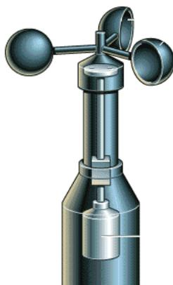
**Figura 4.11** – Anemômetro de conchas. Fonte: Rincondelvago (2009).
