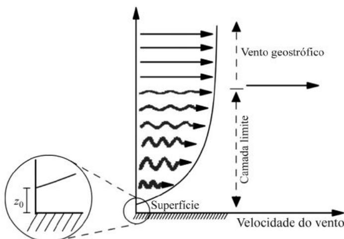
**Figura 6.4** – Perfil vertical da velocidade do vento desde a superfície até a altura do vento geostrófico. O comprimento de rugosidade ( $z_0$ ) é a altura na qual a velocidade é nula. Fonte: (Martins, F.R. et al., 2007).
