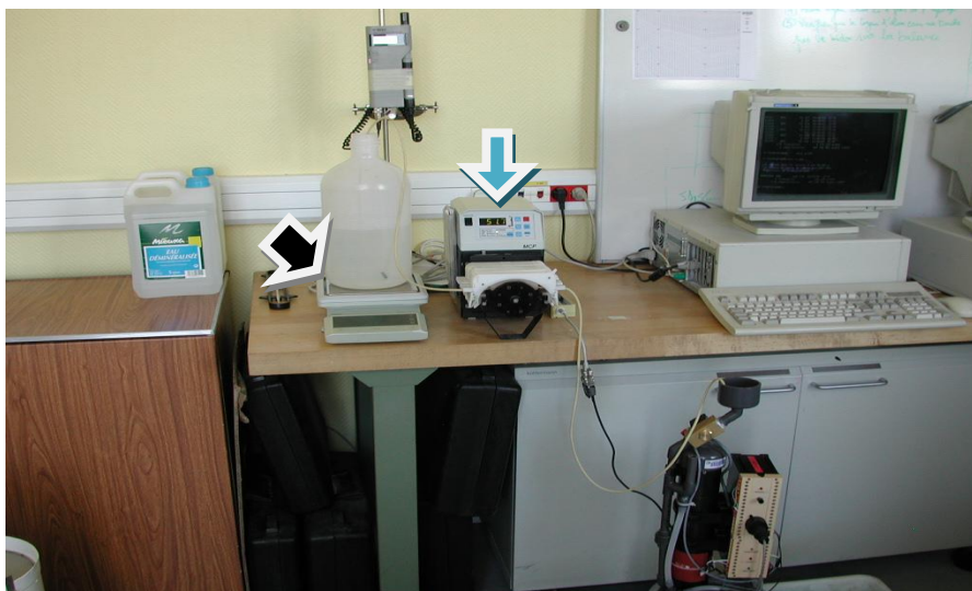
Foto 2: Bancada de calibração: balança de precisão (seta preta); bomba peristáltica (seta azul).
