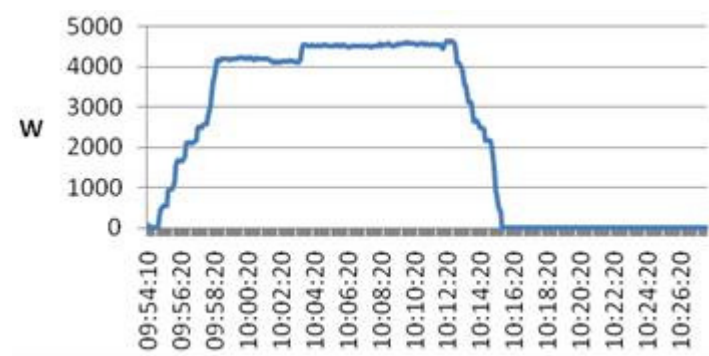
Figura 4-3. Potência máxima de iluminação artificial.
