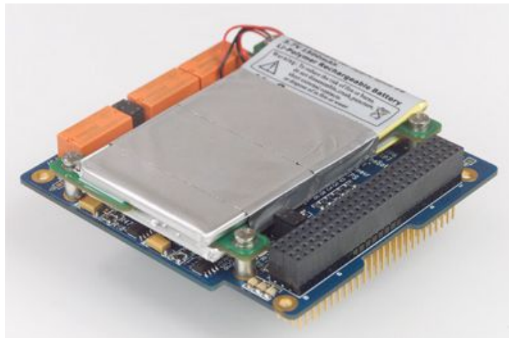
Figura 17: Subsistema de Potência 1U – CubeSat Kit, Pumpkin 16 .
