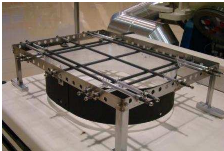
Figura 14 - Modelo dos IRAs com baffle preparados.
