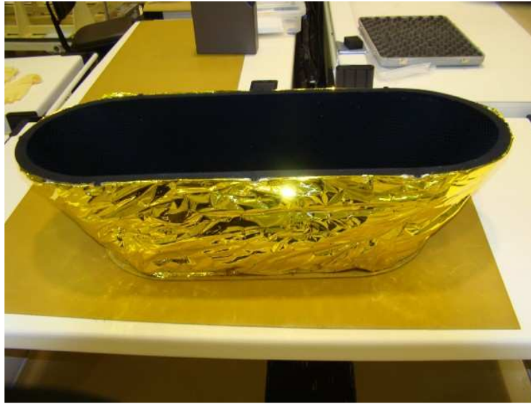
Figura 6 - Modelo estrutural de uma câmara imagiadora de satélite
