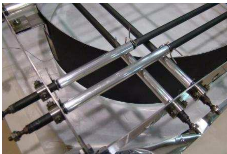
Figura 15 - Detalhe da fixação dos CAL-RODs no suporte.
