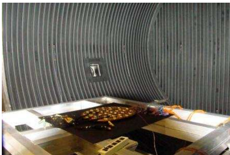
Figura 13 - Modelo de placa imagiadoras pronta para teste de calibração dos radiômetros
