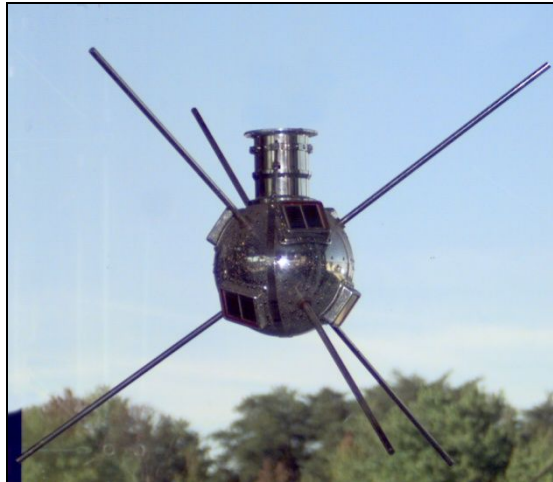
Figura 8 – Vanguard 1, primeiro satélite a utilizar células fotovoltaicas 8 .
