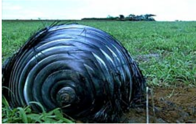
Figura 1.1 – Tanque de Combustível
