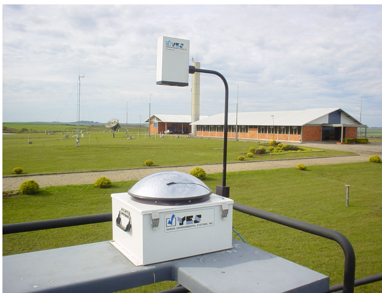
Figura 6.1 – Imageador Total Sky Imager TSI-440 (YES, Inc) instalado na estação SONDA – SMS no Observatório Espacial do Sul – OES/CRS/CIE/INPE – MCT em São Martinho da Serra, RS.
