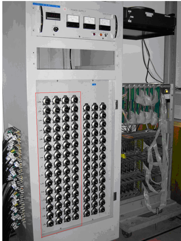
Figura 3.4 – Fontes de alimentação e sistema de processamento de sinais do telescópio detector de muons.
